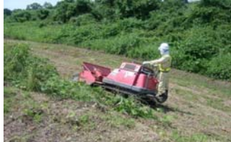
堤防除草の状況(左:ハンドガイド式除草機械 右:大型機械の遠隔操作)
