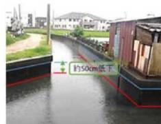
用水路の事前水位低下による雨水貯留
