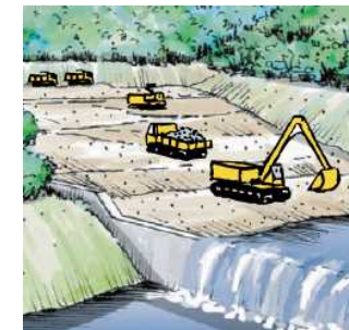
貯砂ダム(貯めて取る)
