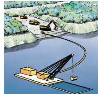
浚渫(取り除く)
