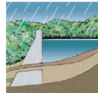
堆砂ゲート(土砂フラッシュ)
