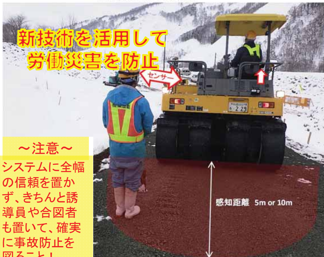
作業員装着警報システム 使用状況
