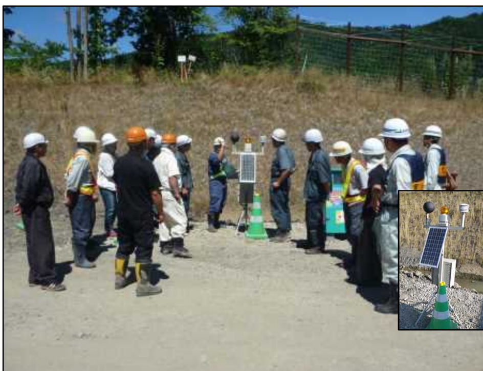
▲熱中症警告アラームおよびWBGT測定器
