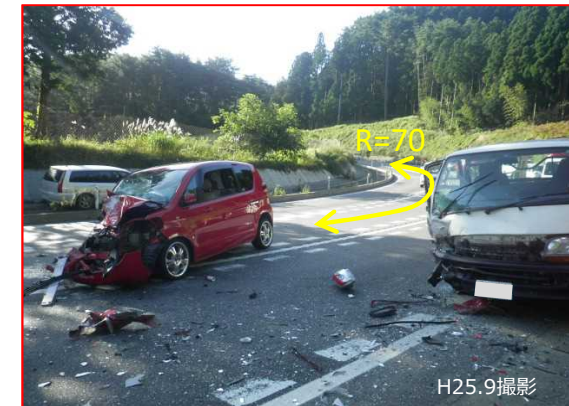
②現道の線形不良 (急カーブ・急勾配) の正面追突事故 (H25.9.24)
