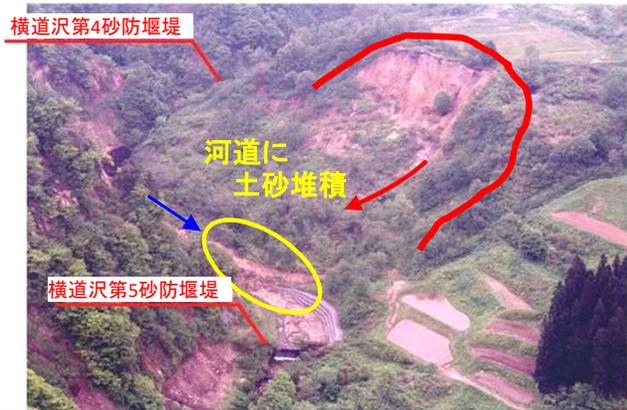
平成16年:横道沢で地すべり発生。崩壊土砂の一部が川の流れを阻害した
