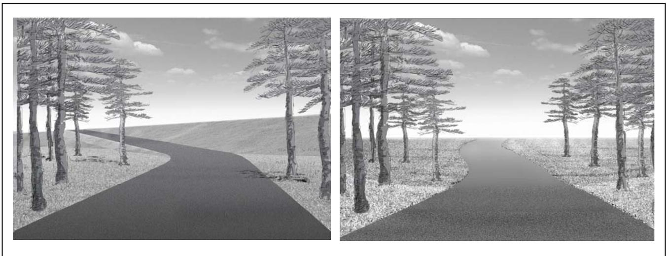
図 3-4-10. アプローチ路（斜路）の整備の一例（一体的に覆土し、斜路方向を変えた場合）
