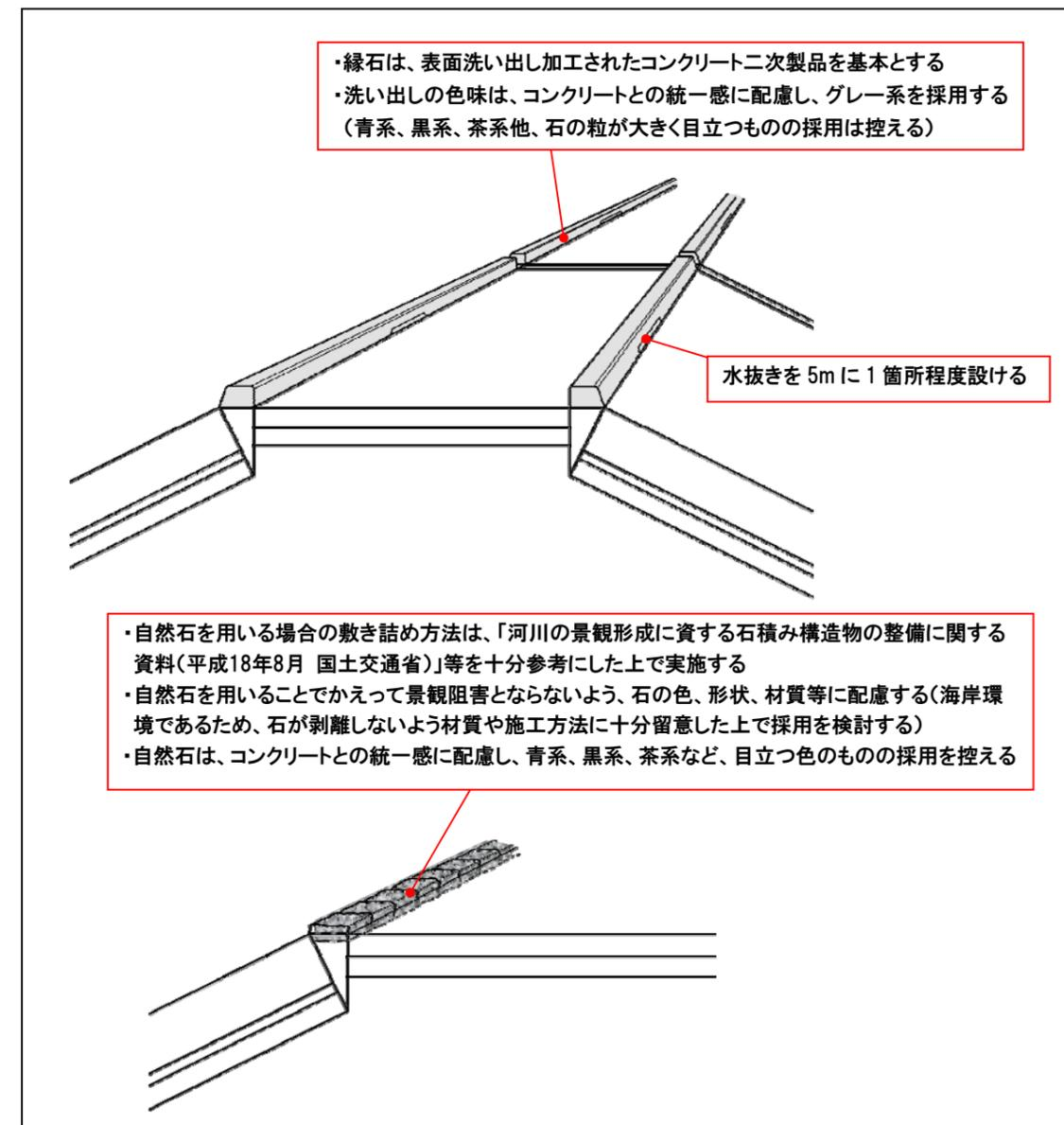
図. 堤防天端の表面処理の例
