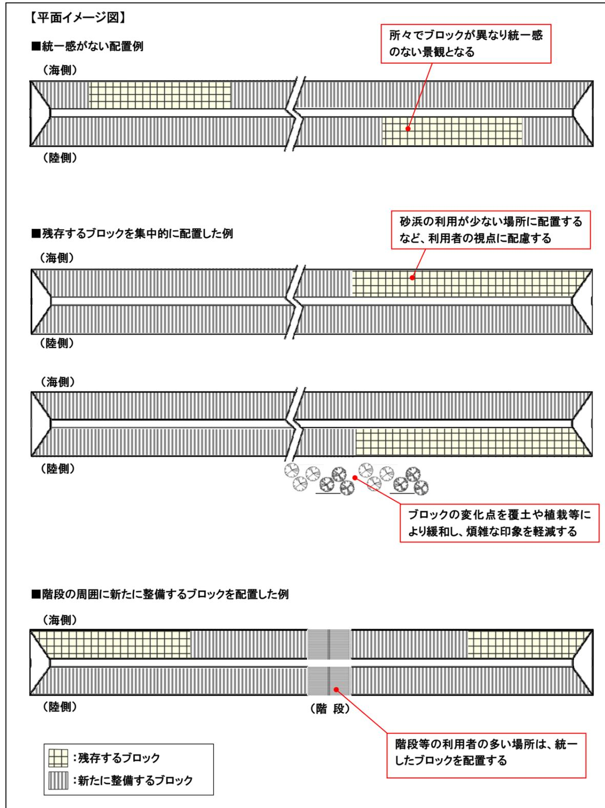
図. 残存するブロックと新たに整備するブロックの配置例
