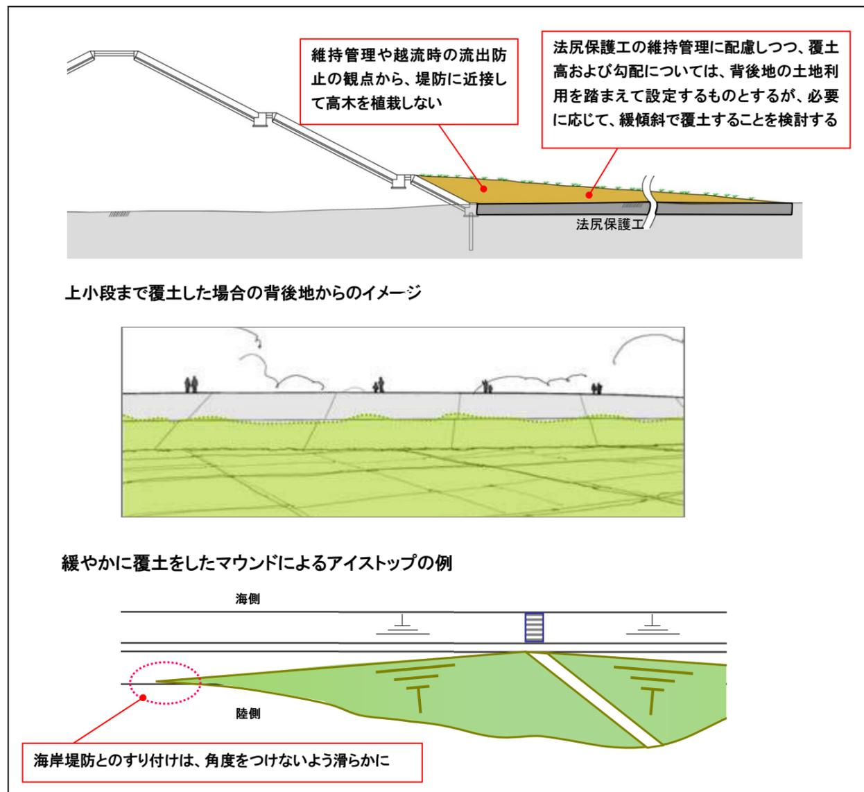
図. 裏法尻への覆土の例
