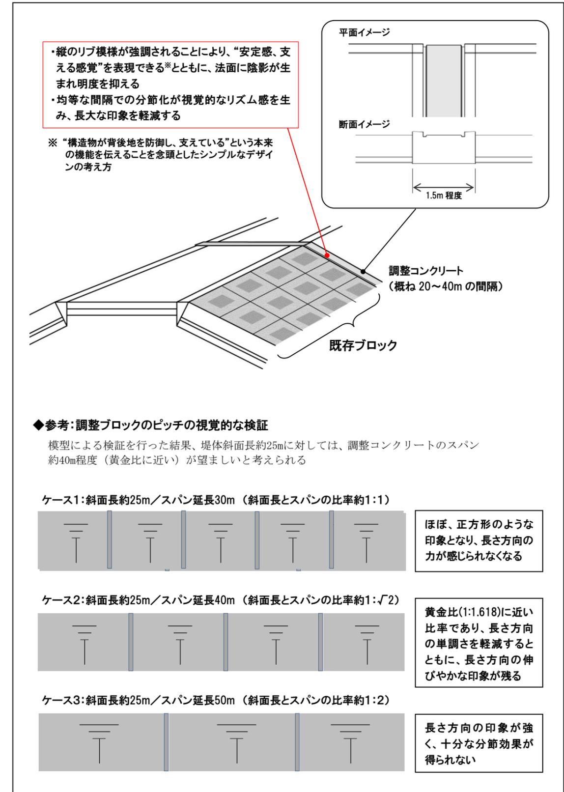
図. 被覆コンクリートブロックの表面処理の例(2)
