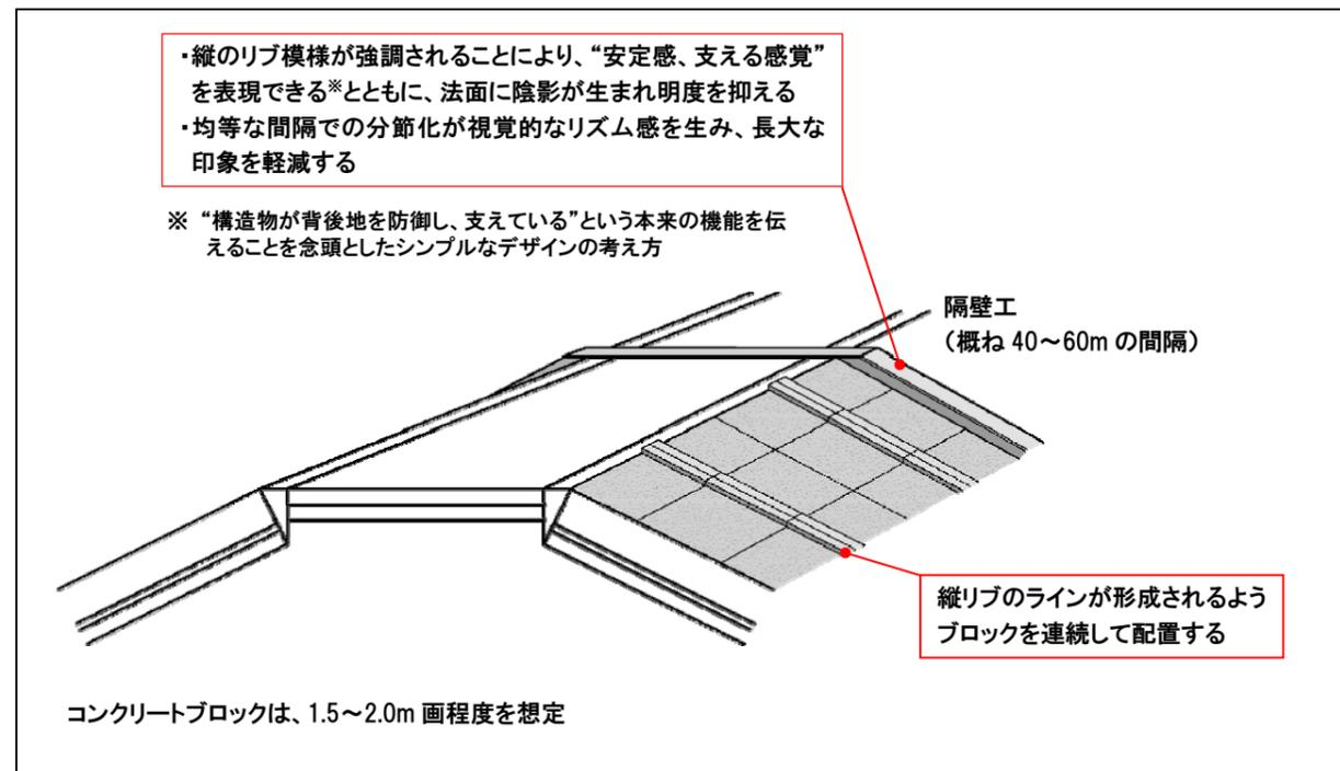
図. 被覆コンクリートブロックの表面処理の例(1)
