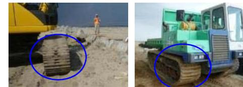
バックホウ、キャリアダンプとも「クローラー式」
