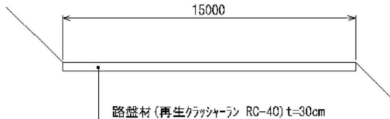
図 3.1.9 標準横断図 (砂れき層)
