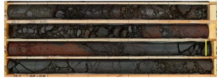
BR-2 孔 (26~30m) 黄線：計画高位置 地質：Ab2, Ab3, Ab0 (図上の地質区分：ABU)、 組み合わせ：C' IV または II c 岩級：CLL または CL RQD：概ね 10 以下 Lu=14
