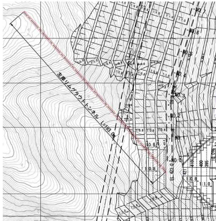
図 3.9.1 左岸リムグラウトトンネル配置平面図
