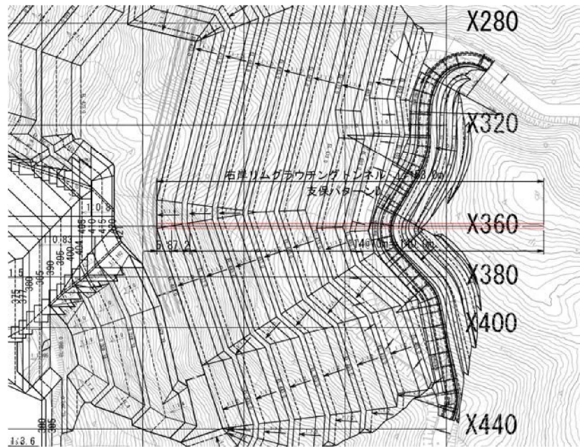
図 3.9.3 右岸リムグラウトトンネル配置平面図
