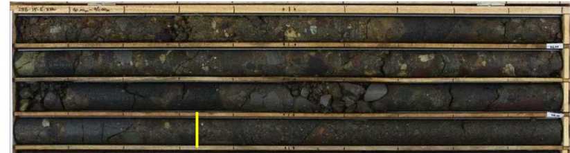
28B-14 孔 (40~44m) 黄線：計画高位置 地質：Tb1, Lp (図上の地質区分：TB(3))、 組み合わせ：D III b または c および C II b 岩級：CLL または CL および CLH (C II b) RQD：概ね 0 だし 42.7m 以深は 60 程度 Lu=50<
