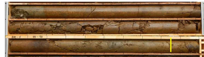
BR-5 孔 (88~91m) 黄線：計画高位置 地質：Tb1 (図上の地質区分：TB(4))、 組み合わせ：C II または III b 岩級：CLH または CL RQD：概ね 30~60 Lu=50< (~90m)、50< (90m~)
