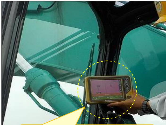
バックホウのバケットに位置情報が搭載され、半自動で設定値以上に掘削出来ない方式となっています。
