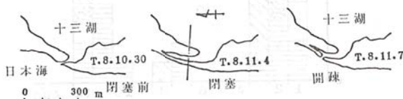
図-5 北偏による閉塞例
