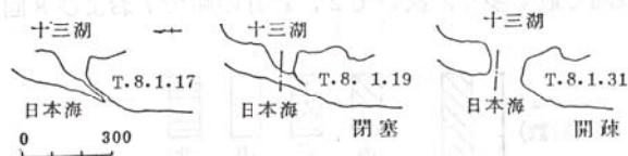
図-4 南偏による閉塞例
