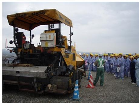
舗装幅9mのアスファルトフィニッシャー
