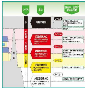
水位表示の例（橋脚）
