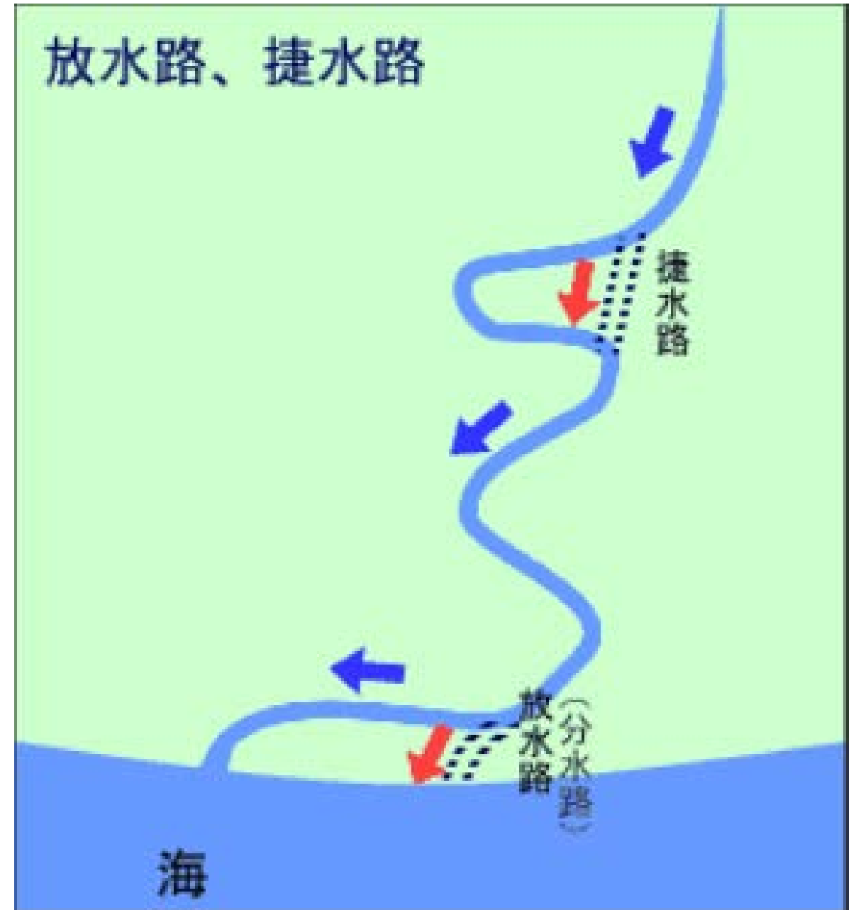
しょう水路・放水路の仕組み
