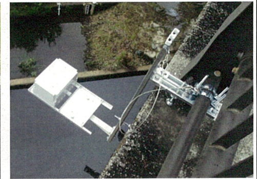
橋梁に設置するタイプ (電波や超音波で河川に触れずに計測)
