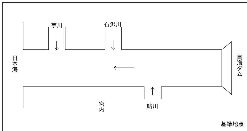
図 4-3 流水の正常な機能を維持するために必要な流量における基準地点
