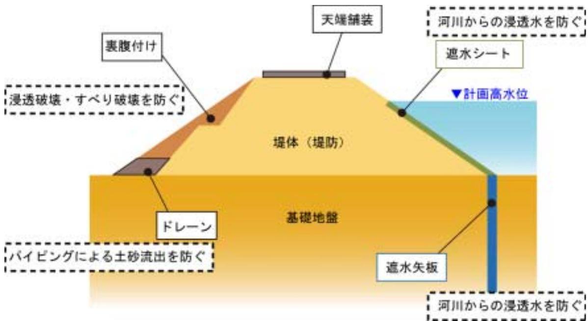
図 5-4 堤防の質的整備断面イメージ
