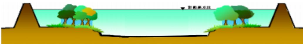
しかし、この木々を放っておくと、繁茂・拡大し、流下能力を阻害して河道内の水位が上昇してしまいます。
