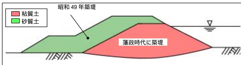
図 3-3 堤防の構造（左岸 9.0km 付近）
