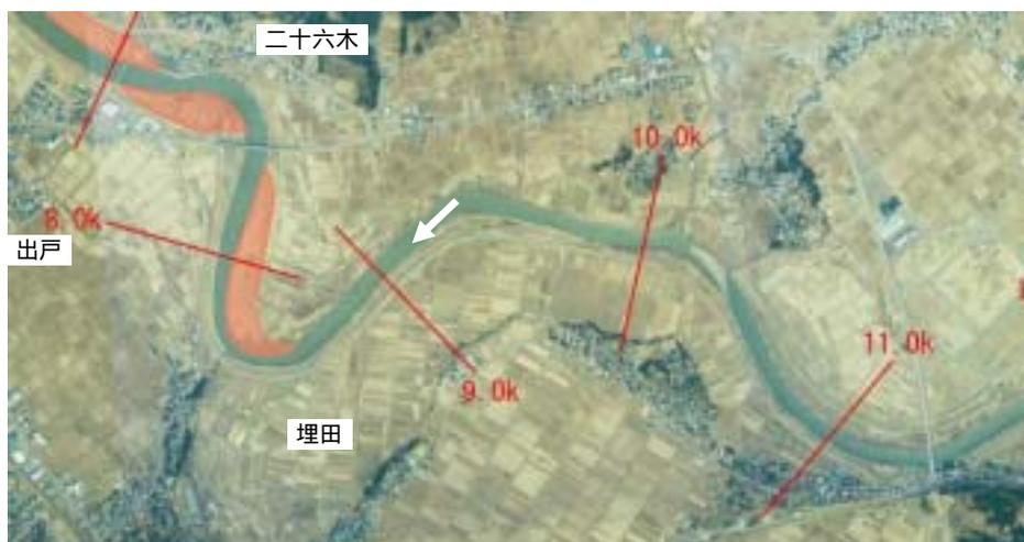
図 5-9 河道掘削位置図 (7.0～11.0k)
