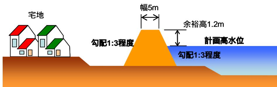
図 5-3 堤防整備横断面図イメージ
