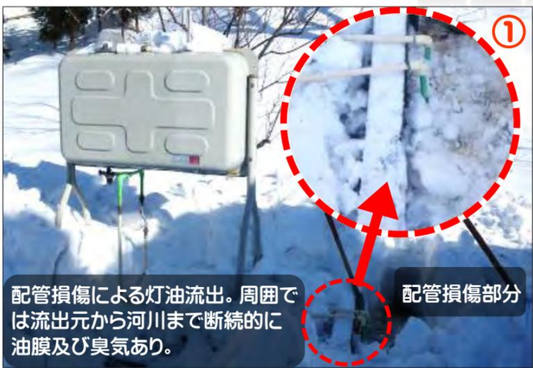
配管損傷による灯油流出。周囲では流出元から河川まで断続的に油膜及び臭気あり。
