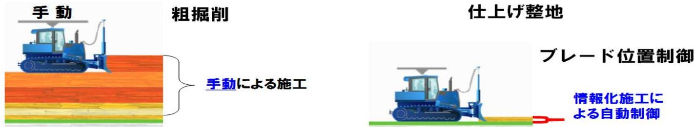
ブレード位置制御のみだったので軽負荷の仕上げ整地施工のみ自動制御を使用
