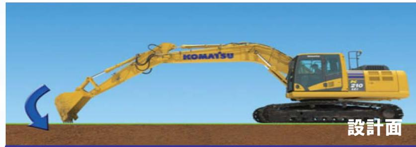
ブームまたはバケットを操作した際に、バケット刃先が設計面に達すると作業機が自動停止。
