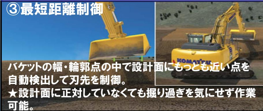
バケットの幅・輪郭点の中で設計面にもっとも近い点を自動検出して刃先を制御。
