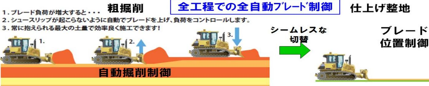
自動掘削制御から自動整地制御へのシームレスな切替によってオペレータは前後左右にブルを走行させるだけで施工を完了。
