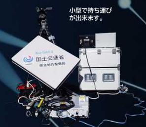
Ku-SAT(衛星小型画像伝送装置)
