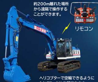
分解対応型遠隔バックホウ(1.0m<sup>3</sup>級)
