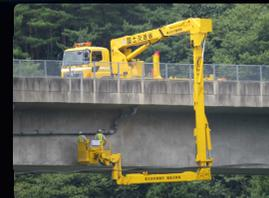
橋梁点検車は、橋の下に潜り込み、橋梁の状態を把握し異常及び損傷箇所を点検～調査する車両です。
