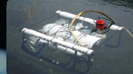
水中探査装置は、水中の施設、設備の異常、損傷を点検～調査する機械です。
