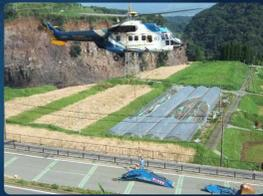
分解対応型遠隔バックホウは、無線操縦が可能な機械で、分解して、ヘリコプターで空輸することができる機械です。
