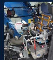
簡易遠隔操縦装置(ロボQS)
