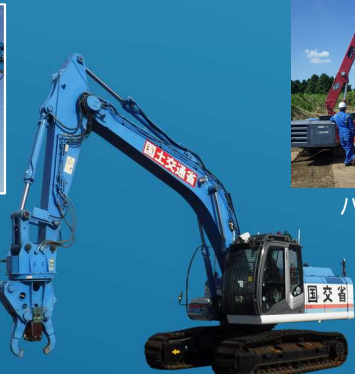
<把持(はじ)装置> 大型土のうを掴んで設置する装置
