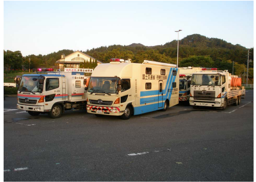
排水ポンプ車 待機支援車 道の駅 たのはた
