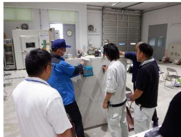
非破壊検査(鉄筋探査)体験
