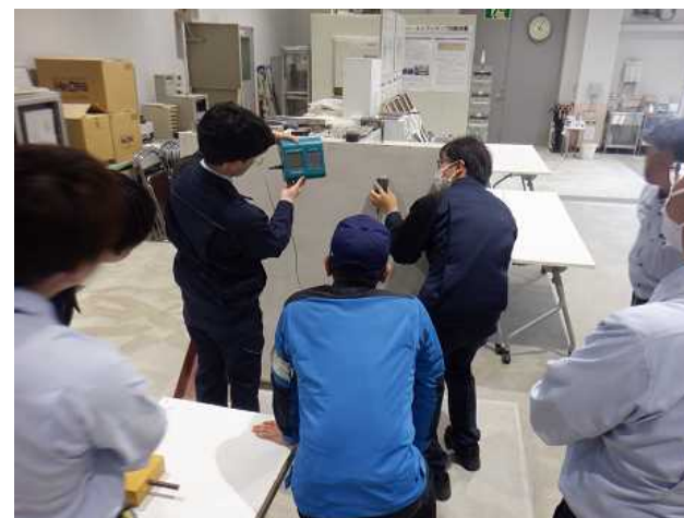
非破壊検査(鉄筋探査)体験
