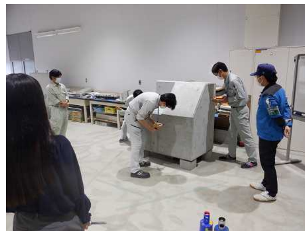
非破壊検査(テストハンマー)体験
