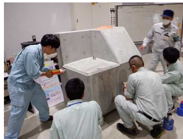
非破壊検査(テストハンマー)体験
