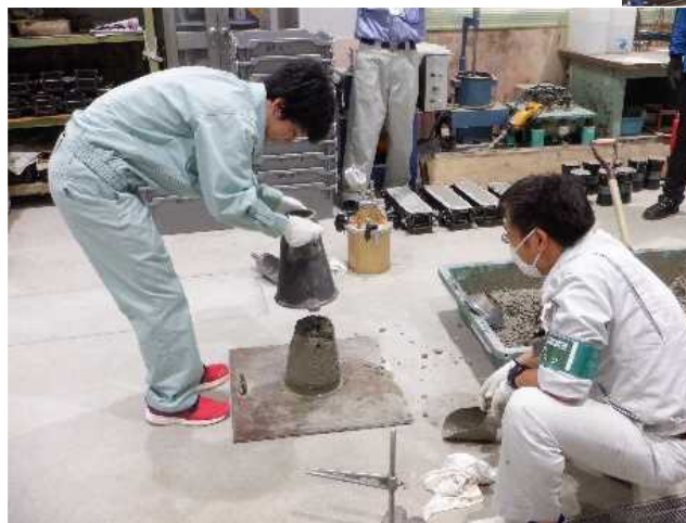
▲ コンクリート材料試験実習（左：スランブ 右：空気量の測定）
