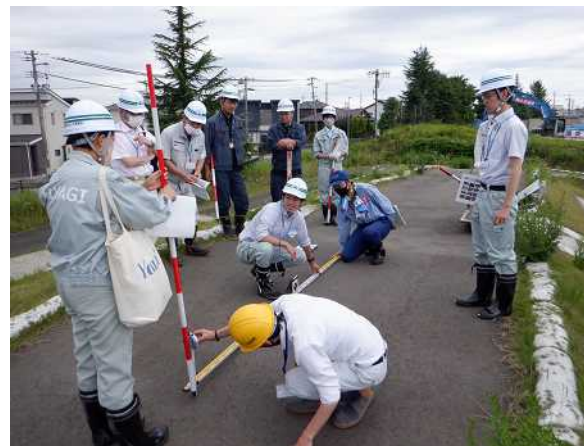
堤防の抜け上がりの計測
