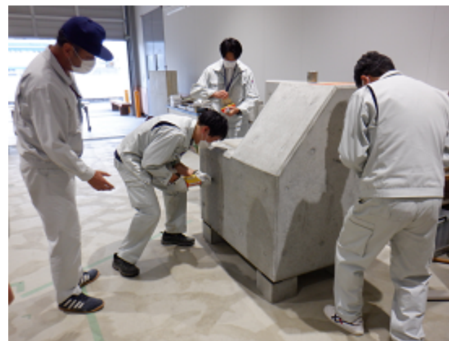
非破壊検査(テストハンマー)体験
