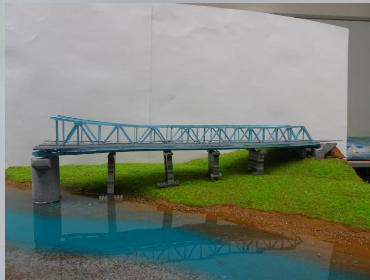
P1橋脚まで組み立てを完了した状況 ナノブロックをベントに見立てている
