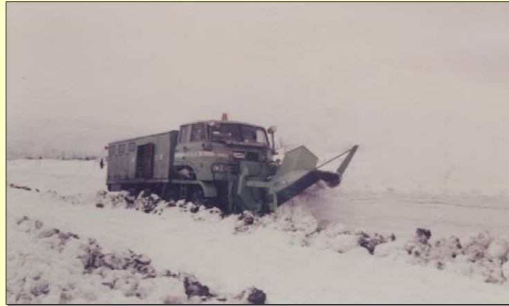
昭和48年 斜流ブローモデル実験 (バイルハックHS293)
