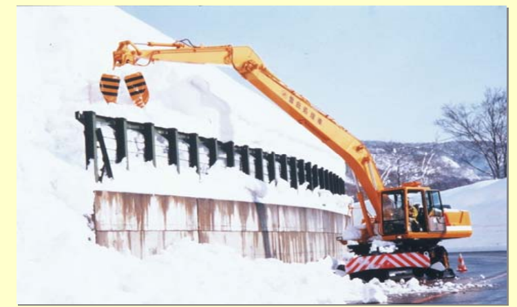
平成5年 雪庇処理機 (法面切り崩し作業)
