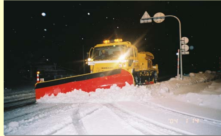
平成6年 除雪トラック(10t 4×4) (夜間作業状況)
