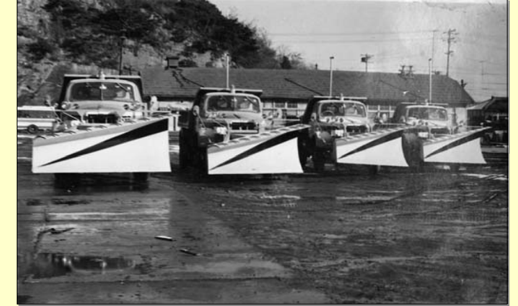
昭和37年 当事務所前に並んだS-1型 スノープラウを架装した除雪トラック
