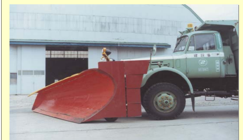
昭和54年 雪堤成形付プラウ装置製作
