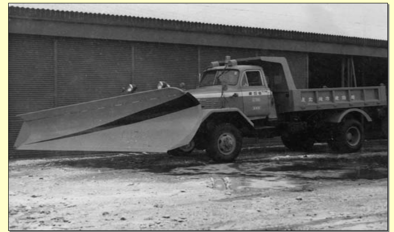
昭和42年 SL4スノープラウ搭載除雪トラック
