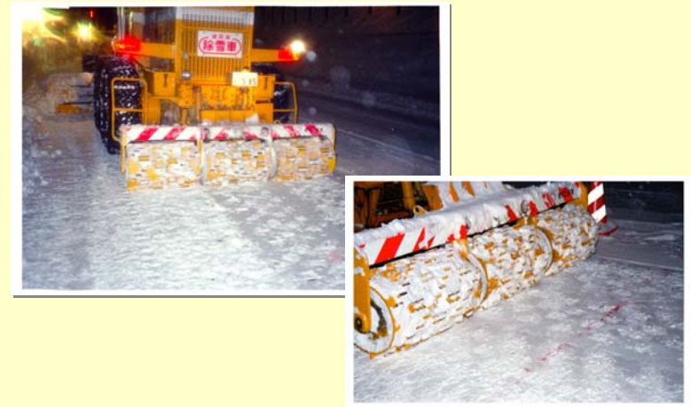
昭和63年 除雪グレーダ防滑装置試験 (ツルツル路面对策)
