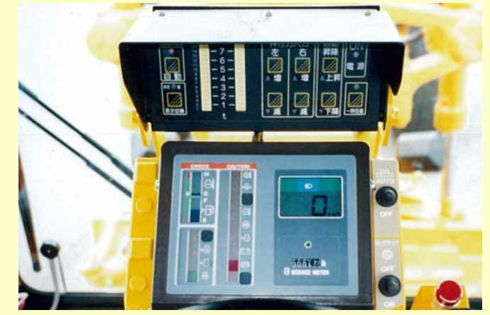
平成元年 除雪グレーダオートブレード タッチパネル
