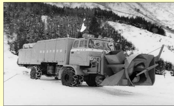
昭和42年 ワンステージ形高速ロータリ除雪車 (SR300型)性能試験
