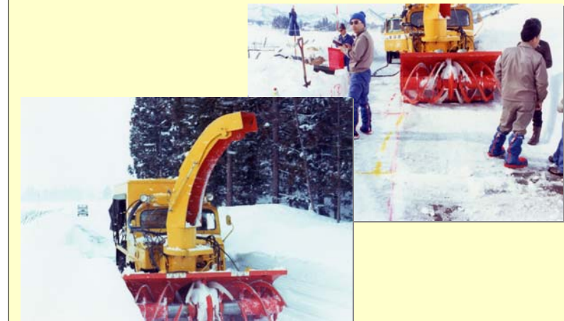
昭和53年 作業幅員可変型ロータリ除雪車性能調査
