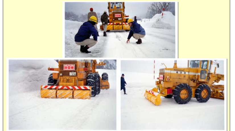
昭和63年 除雪グレーダ防滑装置試験 (ツルツル路面对策)
