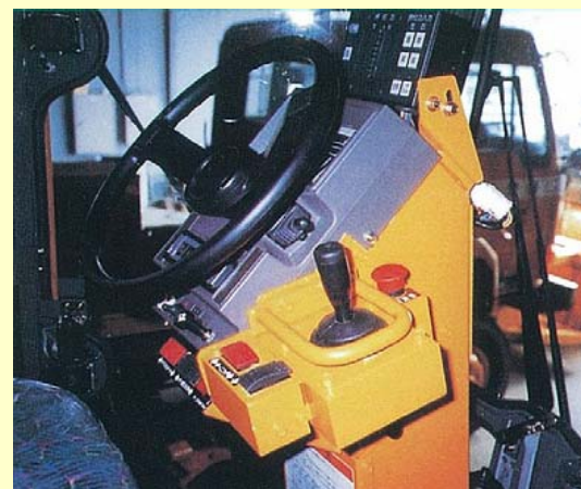
平成9年 除雪グレーダのジョイスティックレバー化 (操作レバーの集約による操作性向上)
