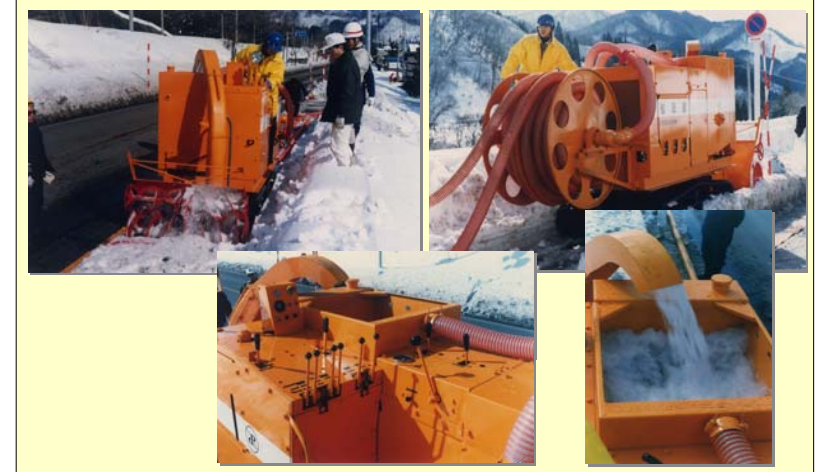
昭和61年 雪の連続輸送機(SW-100P) 現地試験(湯沢市)
