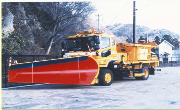
平成6年 除雪トラック(10t 4×4) (機動性のアップと多機能化を両立)
