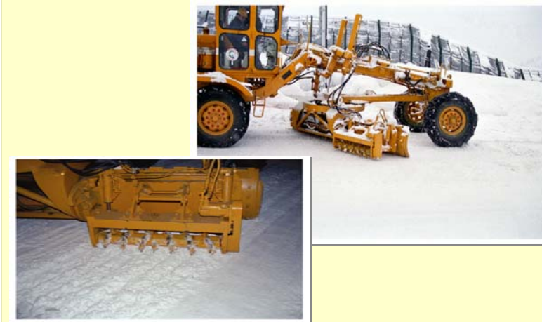
昭和63年 除雪グレーダ防滑装置試験 (ツルツル路面对策)
