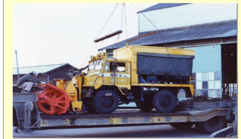
昭和53年 性能試験に向けた作業幅員可変型ロータリ除雪車の積込状況
