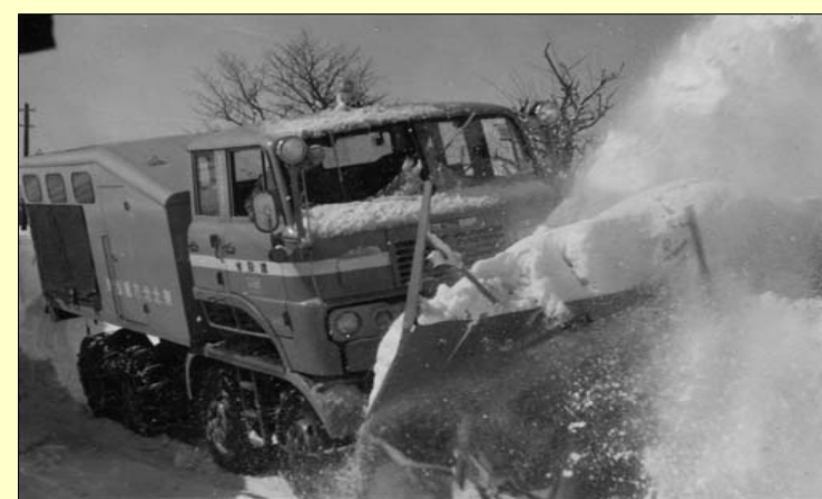
昭和41年 ツーステージ形大型ロータリ除雪車 (SR250)性能試験(尾花沢市)
