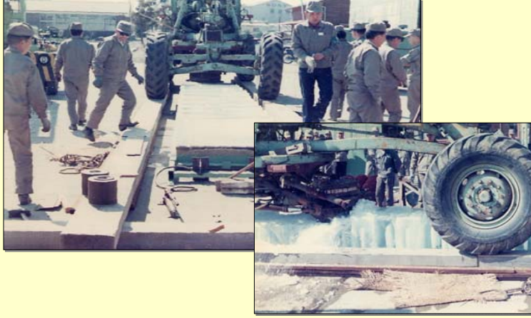
昭和46年 水平円盤カッター式氷盤破碎装置 構内試験
