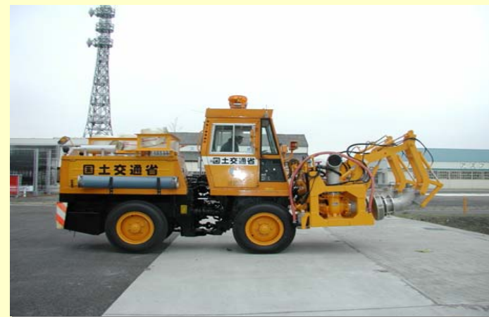
平成15年 除雪機械の通年化活用 (小形除雪車用排水ポンプ装置の開発)
