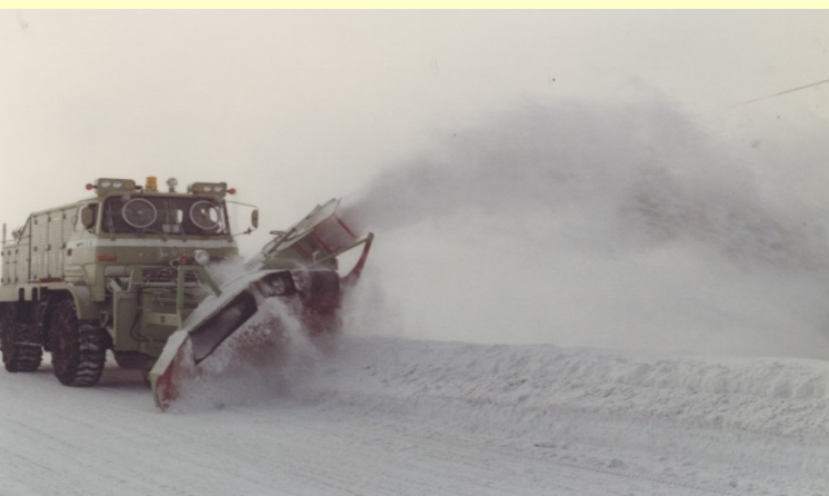
昭和45年 高速ロータリ除雪車(SR303)
