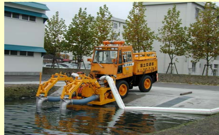
平成15年 除雪機械の通年化活用 (排水ポンプ装置試験)
