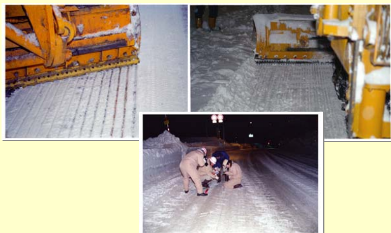
昭和63年 粗面形成ブレード現地試験 (ツルツル路面对策)
