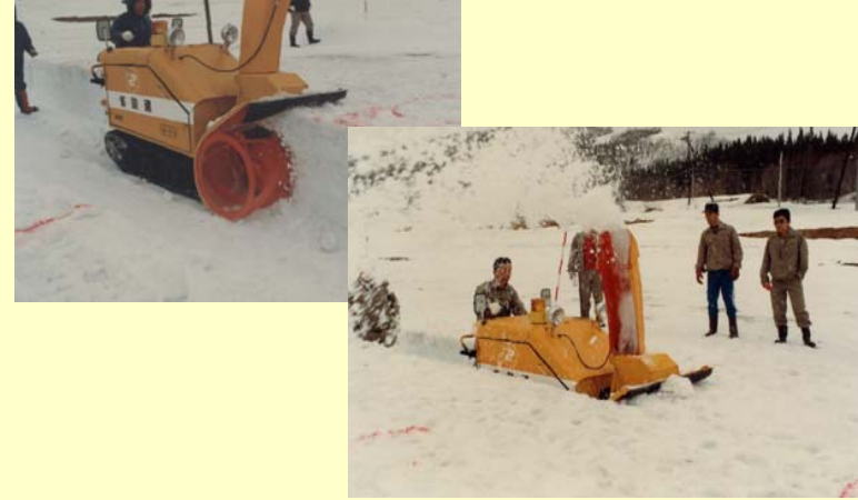
昭和55年 SC-3型小形除雪機 性能試験
