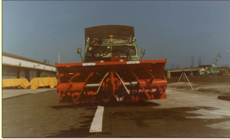
昭和51年 作業幅員可変型除雪装置製作
