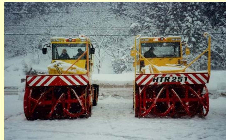
平成6年 都市型ロータリ除雪車 (左-除雪幅2.2m 右-除雪幅2.6m)
