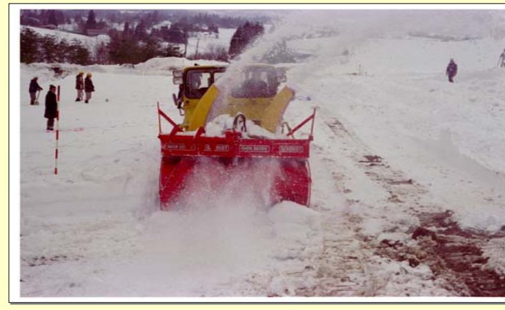
昭和51年 ワンステージカッタ形除雪装置 性能試験(シュミット VF3-HR型)
