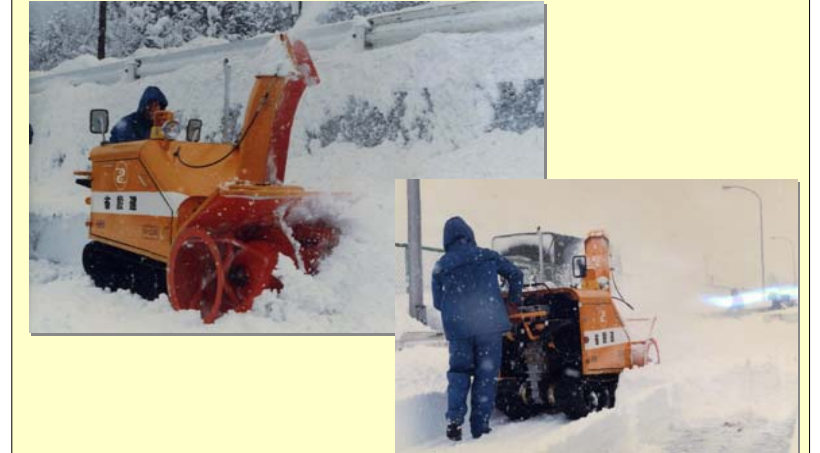
昭和55年 SC46型小形歩道除雪機 性能試験
