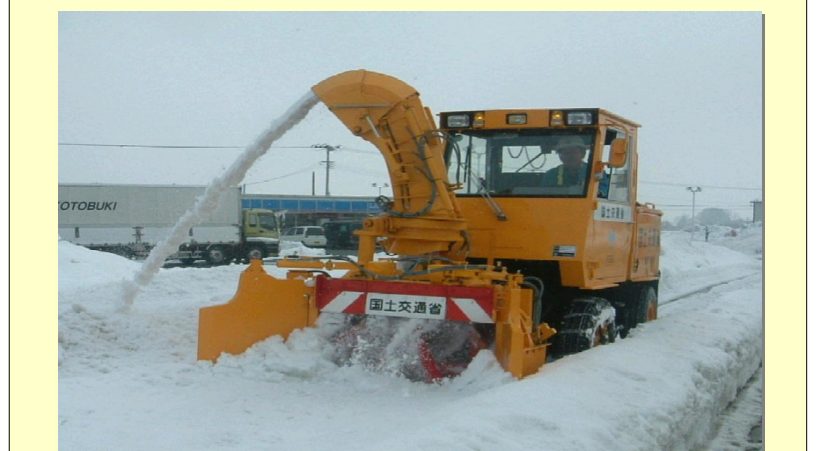
平成16年 幅員可変型小形除雪車 (除雪作業中)
