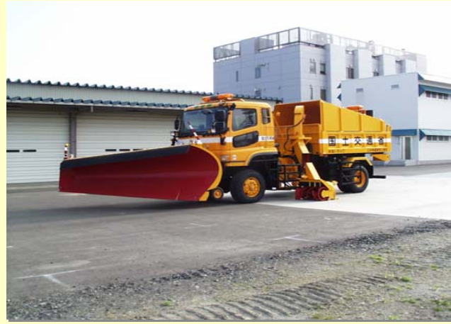
平成13年 運搬排雪車 (投雪できない箇所の拡幅処理用)
