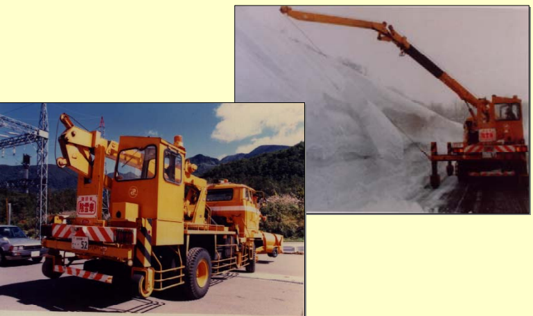
昭和54年 ワイヤー式雪底処理車
