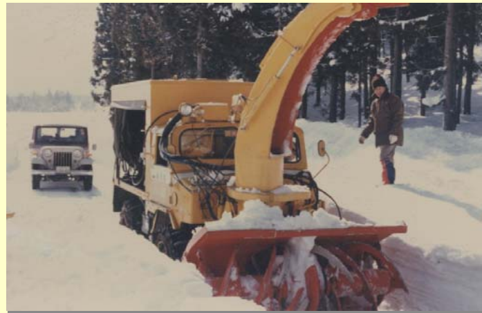
昭和53年 作業幅員可変型ロータリ除雪車性能調査
