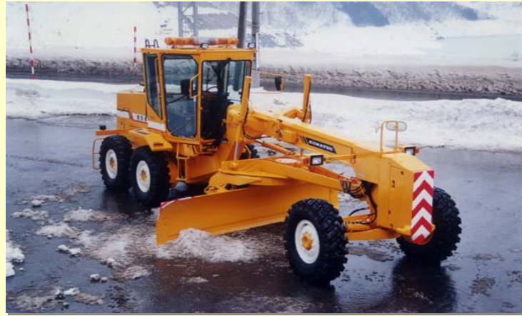
平成元年 高速圧雪整正機 開発1号機 (出力320PS ブレード高0.9m)
