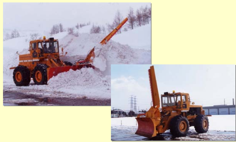
昭和60年 ノコギリ式高雪堤処理装置試験
