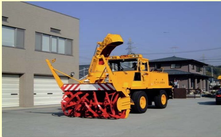
平成6年 都市型ロータリ除雪車 (市街地における交通流阻害の解消 除雪幅2.6m→2.2m)
