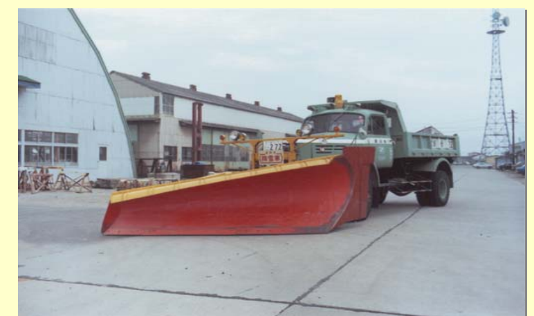
昭和54年 雪堤成形付プラウ装置製作
