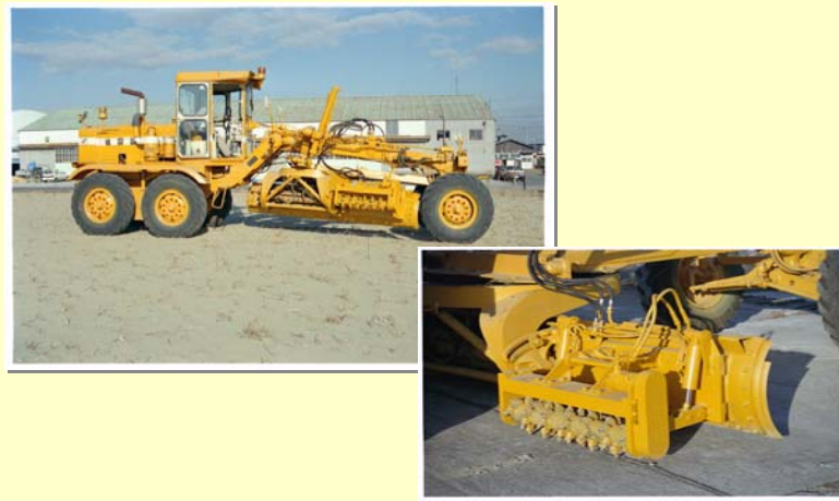
昭和63年 除雪グレーダ防滑装置 (ツルツル路面对策)
