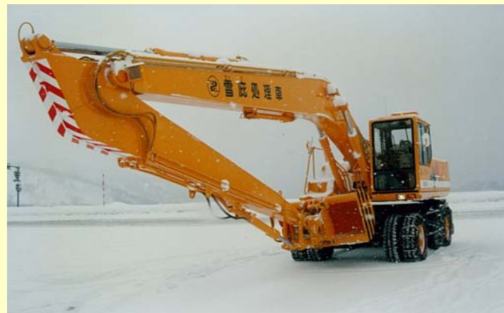
平成5年 雪庇処理機 (雪庇処理作業を人力施工から機械化施工へ)
