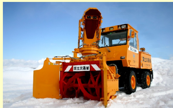
平成16年 幅員可変型小形除雪車 (狭い歩道から広い歩道まで1台で除雪)
