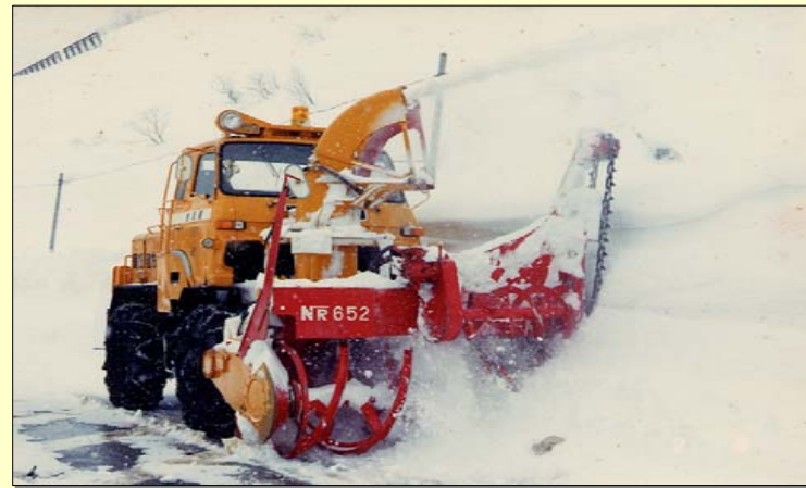
昭和51年 高雪堤処理装置付ロータリ除雪車 性能試験
