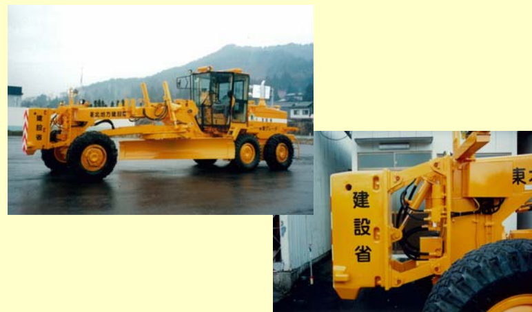
平成4年 除雪グレーダ振動抑制装置 (振動の発生を抑制し乗り心地性能をアップ)
