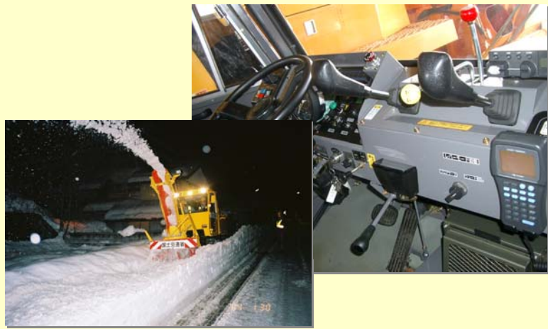
平成10年 小形除雪車のジョイスティックレバー化 (操作レバーの集約による操作性向上)
