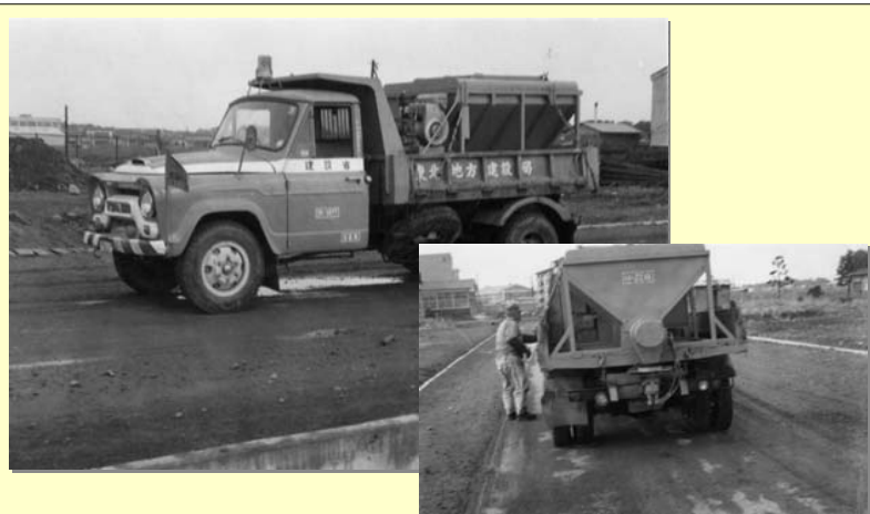
昭和41年 路面の防滑を目的として 開発した砂散布装置
