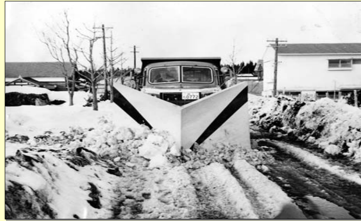
昭和36年 V形スノープラウ開発1号機 (5t 4×4ダンプトラックに架装)
