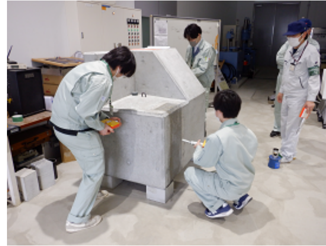
非破壊検査(テストハンマー)体験
