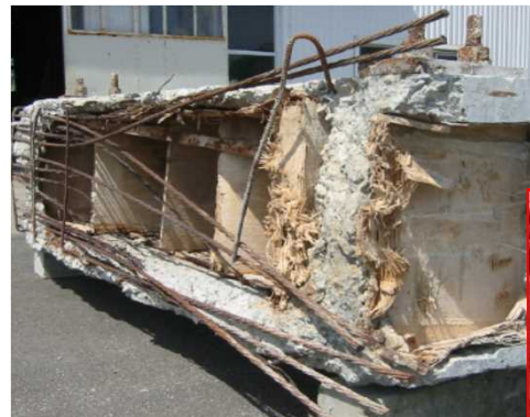
写真-1 桁下面の剥離・鋼材露出
