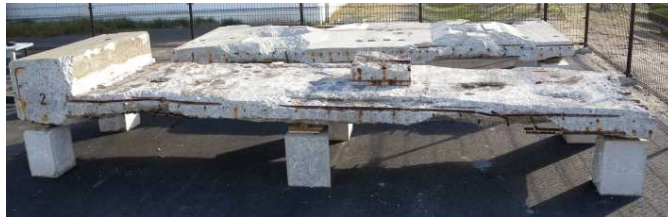
写真 水平ひび割れ状況 (撤去床版)
