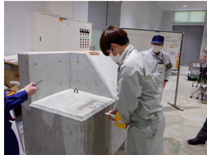
非破壊検査(テストハンマー)体験
