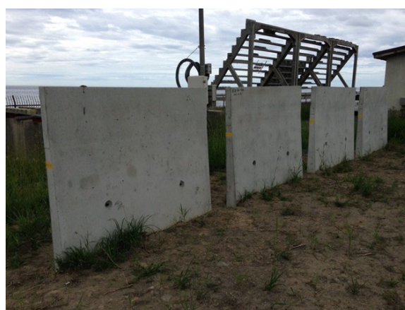
写真-1 暴露試験場への設置状況
