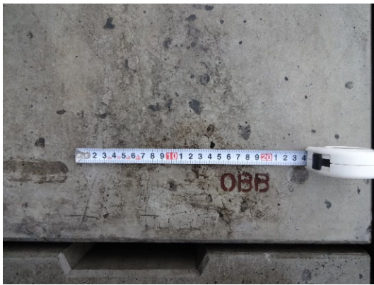
図-4.3 普通骨材+BB (越冬 2 年目)
