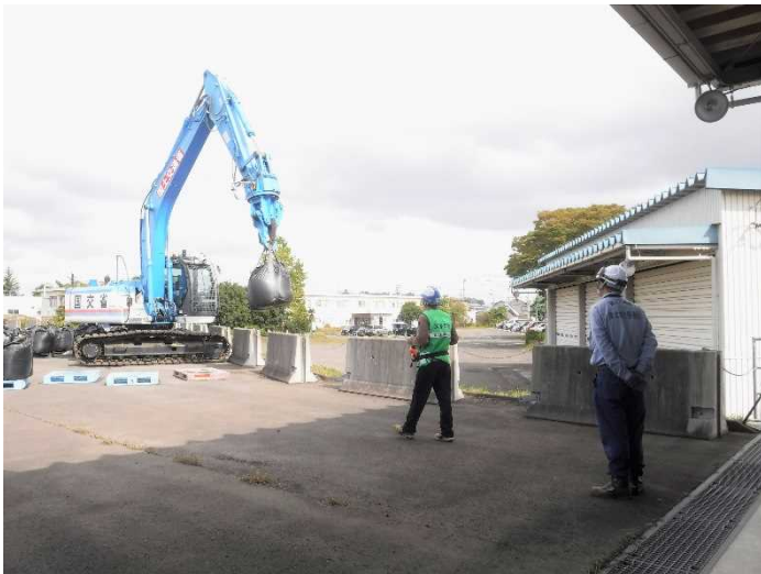
距離が50m以内であれば、目視によりバックホウをリモコン操作
