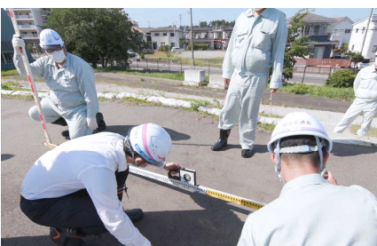
堤防の上げ上がりの計測
