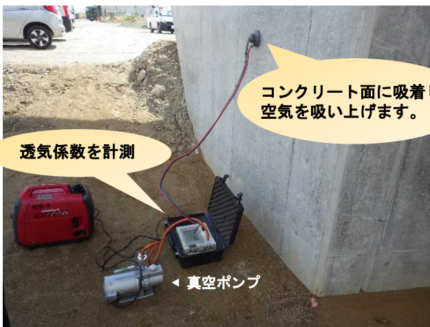
写真-1. 表層透気試験の実施状況
