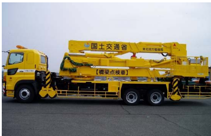
橋梁点検車（全景）
