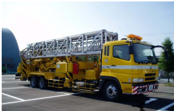
橋梁点検車（全景）
