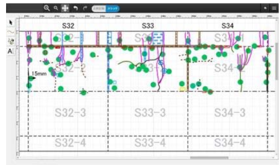
トンネル点検スケッチ画面例
