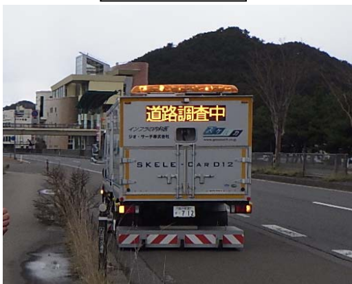
路面下空洞探査車
