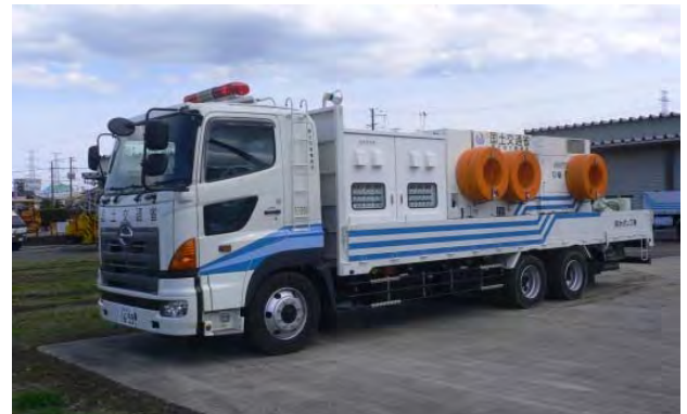
排水ポンプ車 (30m 3 /min高揚程)
