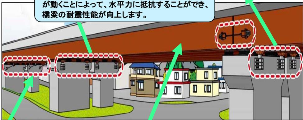
【落橋防止装置】といいます。このPCケーブルによって、橋桁（道路部分）が橋脚から離れないよう、落下を防いでいます。
