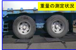
重量の測定状況
