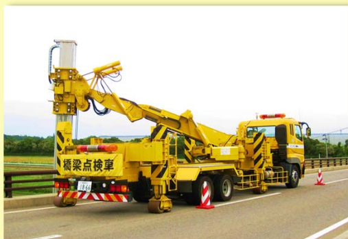
橋の下などを接近して点検するために利用する橋梁点検車
