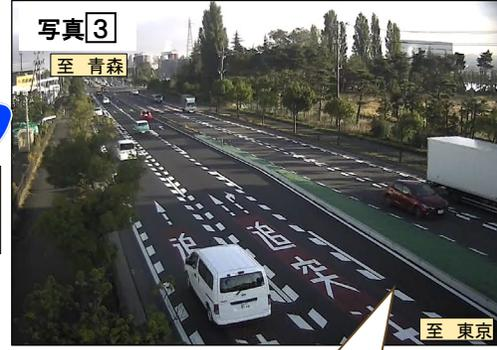
右折レーンの延伸により、右折待ちの滞留による後続直進車の阻害が解消
