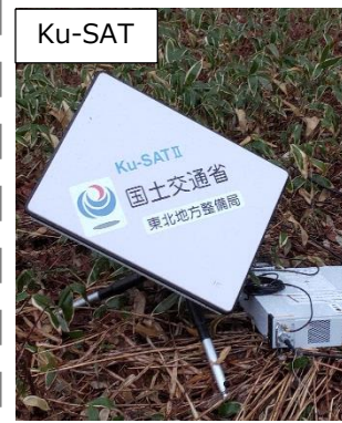
Ku-SAT(衛星小型画像伝送装置)を設置し被災箇所の監視を可能に
