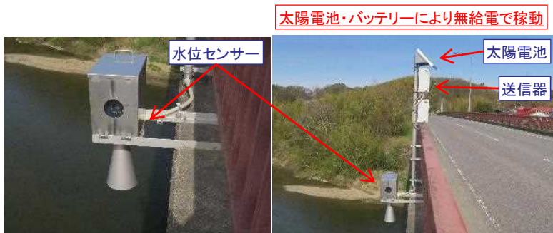
危機管理型水位計設置状況（郡山市西田町鬼生田地先（阿武隈川））
